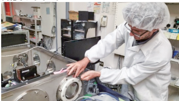
写真3：レーザー照射用チャンバーでフランジの取り付けを行うLukasz氏。
